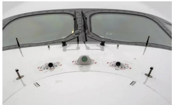
Bild 1 - Der A350-1000 „Dragonfly“ Demonstrator mit seinen drei Kameras © Airbus
