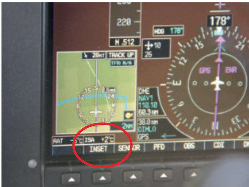
Garmin hat in ihrem G1000 Cockpit für Very Light Jets (hier an Hand einer Citation Mustang) eine Δ ISA Anzeige am PFD.
